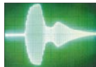
Bild 9: Signal in Stellung Peak + Notch. X-Maßstab 20 ms/Einh. Oszillogramme: OZ9Z1
